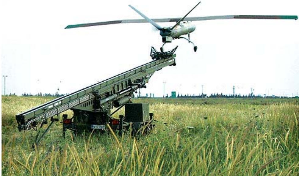
Рисунок 6. Запуск БЛА Hermes 450 с пусковой катапульты
