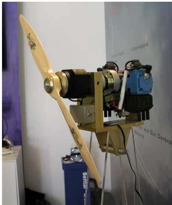
Рисунок 4. Комбинированная силовая установка БЛА
