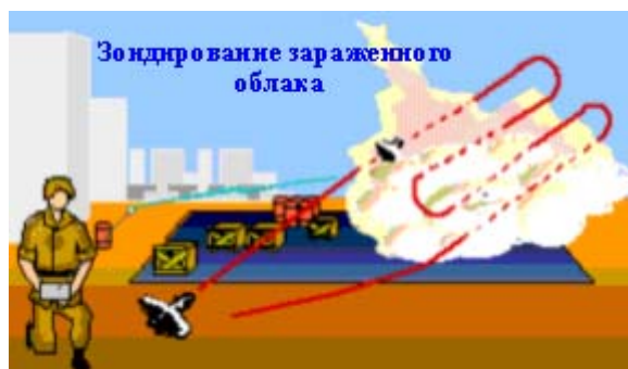
Рис. 2. Мини-БЛА как подвижный датчик
