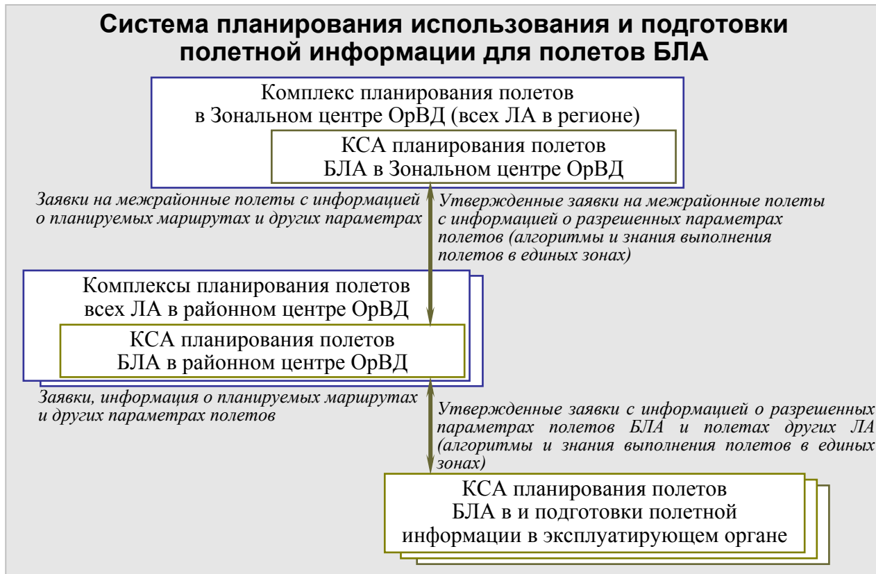
Рисунок 4. Общий вид возможной системы планирования полетов БЛА и разработки полетной информации в структуре организации воздушного движения в регионе и районе
