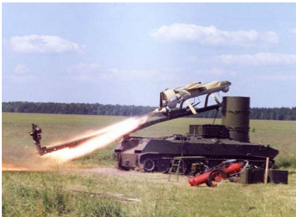
Рисунок 3. Старт «Пчелы» при помощи пороховых ускорителей
