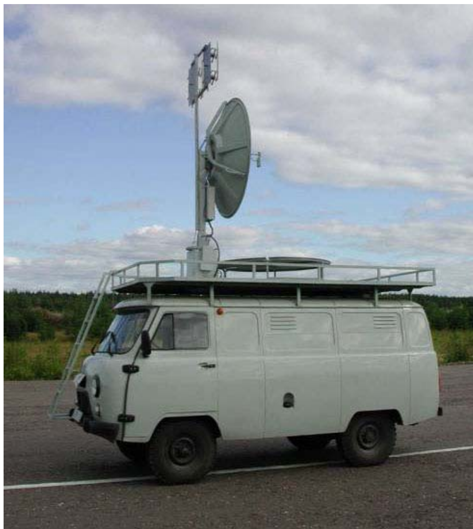
Рисунок 8. базовая автоматизированная рабочая станция (БАРС) комплекса ДПЛА ГранТ с развёрнутыми антеннами
