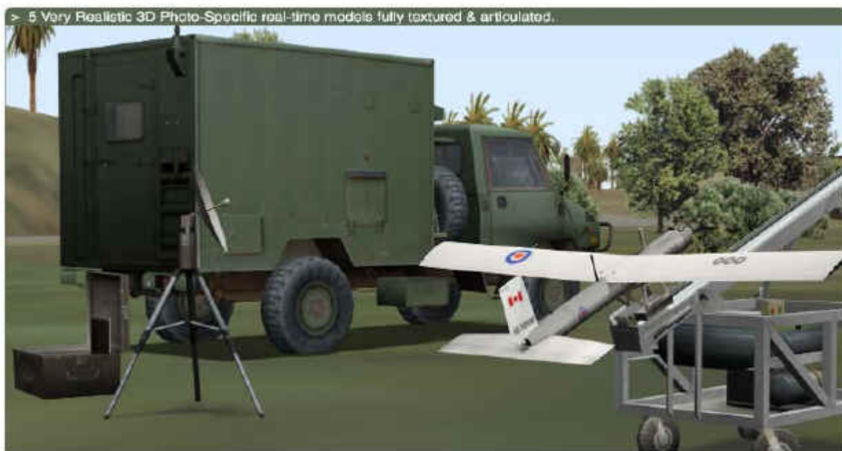
Рисунок 7. 3D модель комплекса ДПЛА Silver Fox для моделирующих и игровых программ из библиотеки фирмы RealDB Inc. (в состав комплекса входит параболическая ТВ антенна на треноге, а пусковая установка заметно больше, чем в брошюре фирмы-разработчика)
